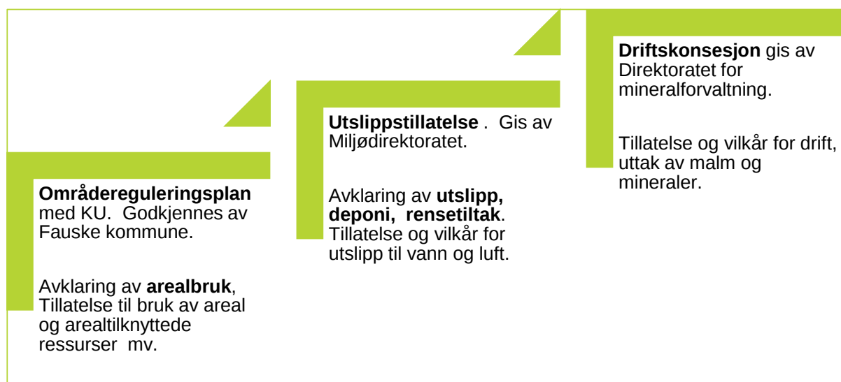
Figur 1. Trinnvis utvikling fram til driftskonsesjon av gruvedrift.
