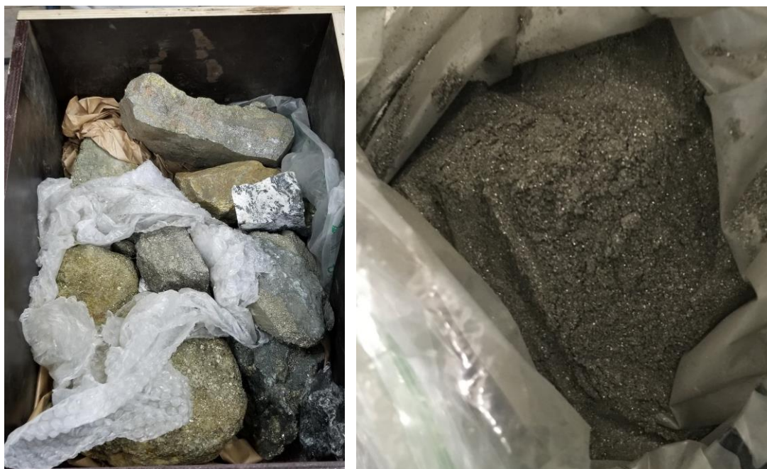
Figur 10. Bilde av materialet som ble brukt til å utføre flotasjonstestene. Dette består i hovedsak av sulfidmalm med noe innslag av sideberg. Bilde to viser avgang etter flotasjonstesten.
